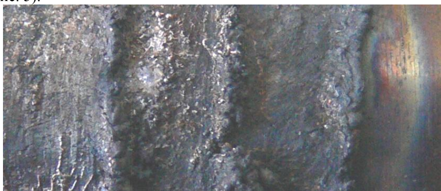
Рис. 5. Поверхность покрытия после ЭКП
