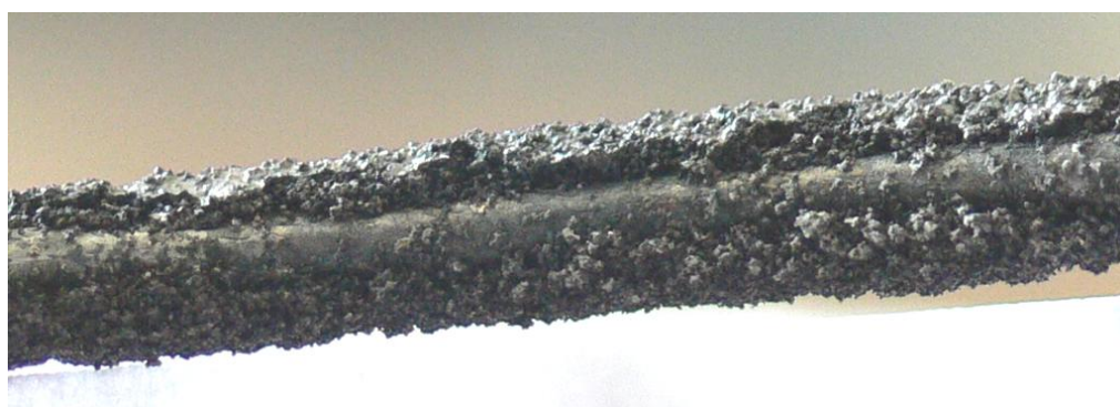
Рис. 6. Оголённая часть порошковой проволоки
