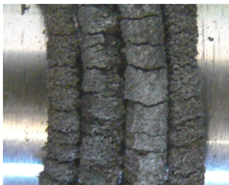
Рис. 4. Трещины на порошковой проволоке
