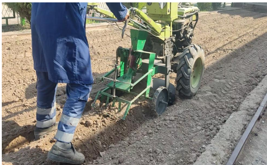
Рис. 3. Посевной агрегат Мотоблок+КМ-0,6-0,3 при выполнении технологического процесса посева репчатого лука
