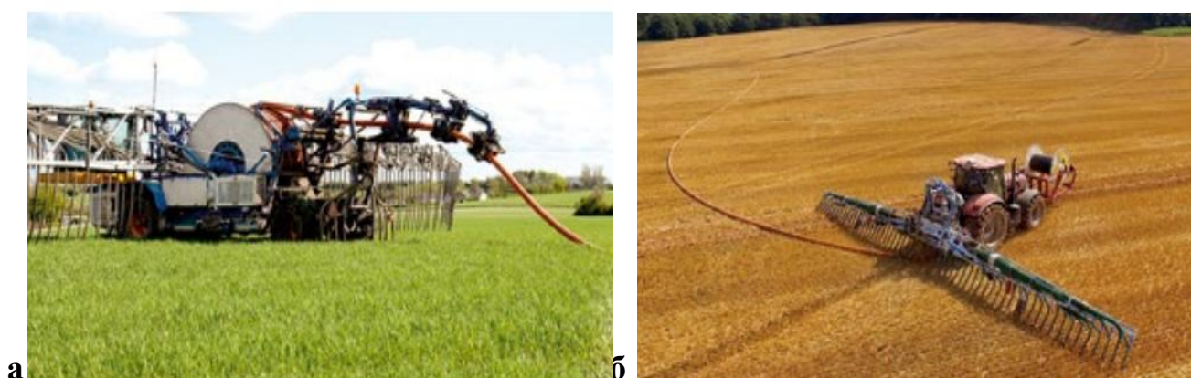
Рис. 5. Специальные системы, работающие по уникальным технологиям а – Agrometer SDS 8000 Trailing shoe; б – «волочащийся башмак»
