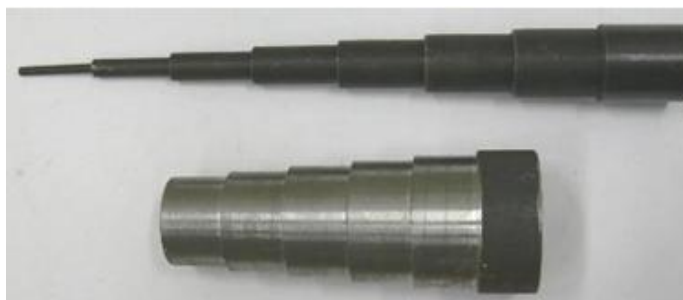
Рис. 1. Ступенчатый вал для определения гибкости спечённых лент
