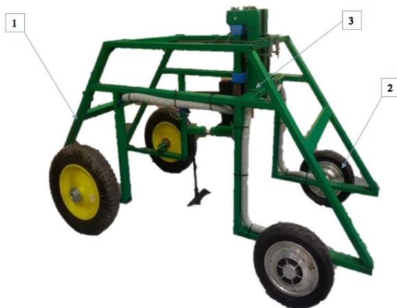
Рис.2. Лабораторная установка автоматизированного секционного рабочего органа 1 – рама, 2 – мотор-колесо, 3 – автоматизированный секционный рабочий орган
