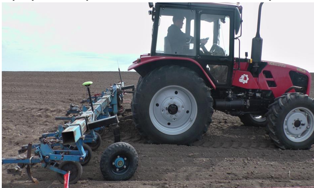
Рис. 1. Проверка траекториальной стабилизации трактора БЕЛАРУС-952.3 с культиватором КРН-5,6В на склоне с применением приемника глобальной навигационной спутниковой системы «Сигма» фирмы Javad
