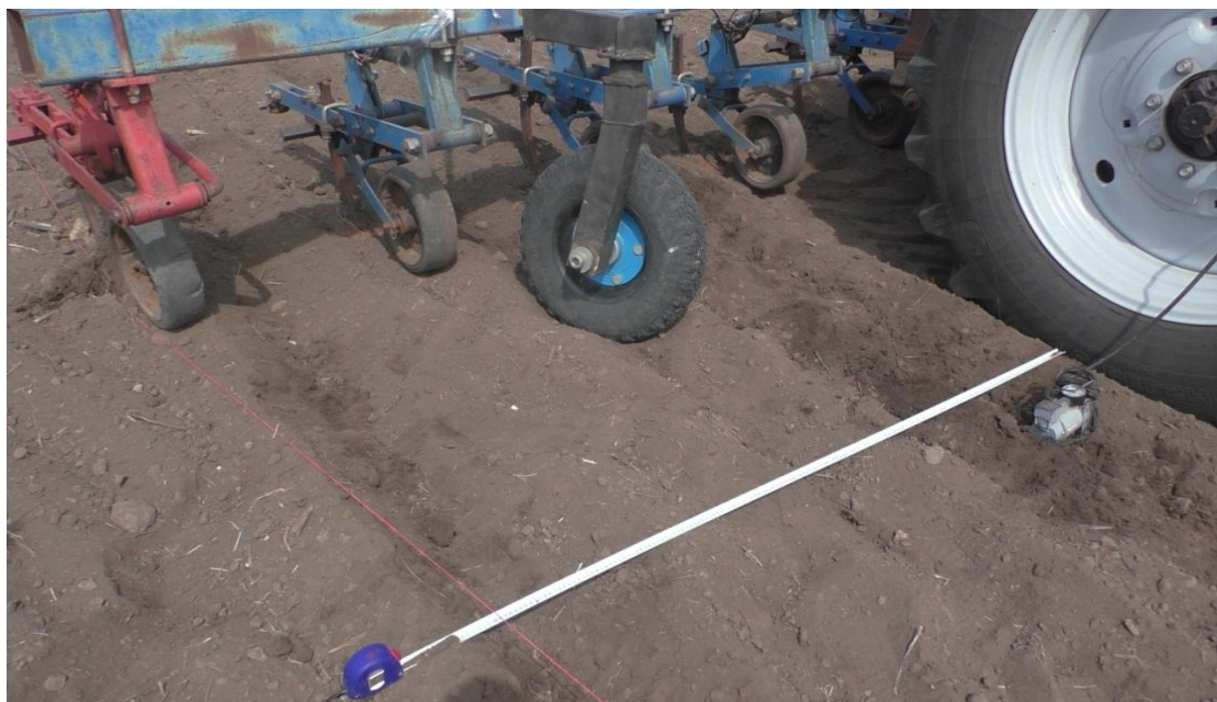
Рис. 2. Проверка траекториальной стабилизации МТА на склоне с применением поворотного механизма
